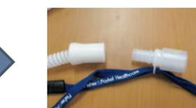
図4 蛇管接続部コネクタの外れ
