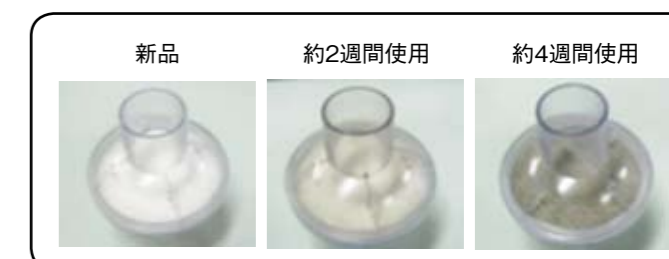
図5 吸気フィルターの汚れ
